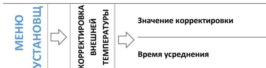
Данная функция используется для корректировки внешнего датчика; она выполняется при установке или после длительного использования регулятора, если отображаемая внешняя температура отклоняется от фактической. Пользователь указывает, каким должно быть *Значение корректировки* (диапазон регулировки: от -10 до +10°C с точностью до 1°C) и *Время усреднения*, т.е. время, в течение которого происходит замер температуры и по истечении которого ее значение будет считано *снова*.
