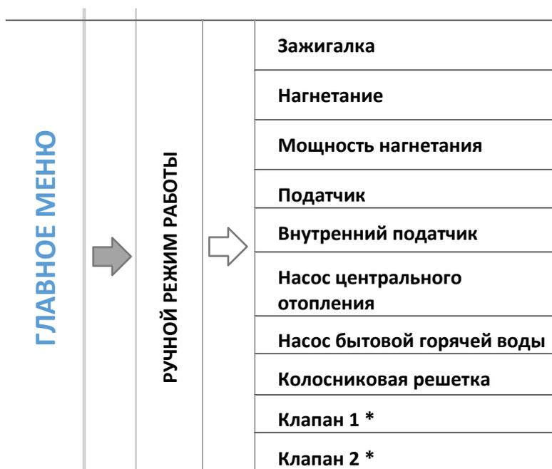
*\*Параметры доступны только после активации вспомогательного клапана в меню установщика (требуется дополнительный модуль управления клапаном, напр: ST-431N).*
