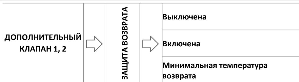
Данная функция позволяет настроить котел на защиту от чрезмерно холодной воды, возвращающейся из основного контура, что может вызвать низкотемпературную коррозию котла. Защита возврата работает таким образом, что при слишком низкой температуре клапан закрывается до тех пор, пока короткий контур котла не достигнет соответствующей температуры.
