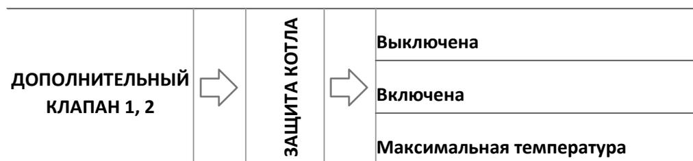
Защита от чрезмерно высокой температуры системы центрального отопления предназначена для предотвращения опасного повышения температуры котла. Пользователь устанавливает максимально допустимую температуру котла. При опасном повышении температуры клапан начинает открываться в домовую систему для охлаждения котла. Эта функция включена постоянно.
