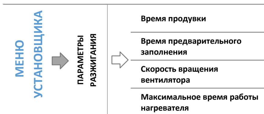
Параметры разжигания означают подробные настройки процесса разжигания. Отрегулируйте настройки в соответствии с типом используемого топлива.
